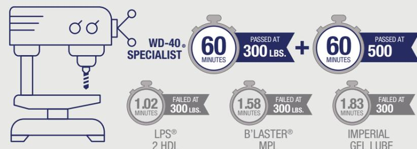
O teste mede o comprimento da lubrificação em libras de força antes da falha.
