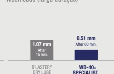
Teste de desgaste de 4 bolas: os resultados mostram a largura da marca após 60 minutos a 12.000 RPM. Teste de modificação (longa duração): Os resultados mostram a largura da marca em momentos especificados. Menor número, significa menos marcas e melhor proteção.
